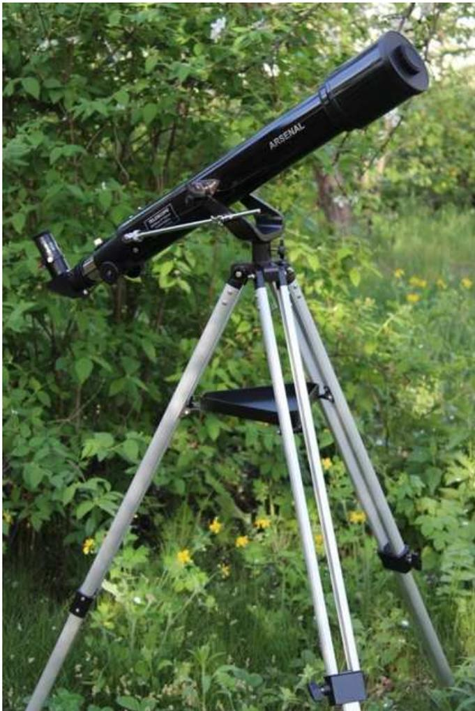
Сверху на штатив устанавливается вилочная азимутальная монтировка, снабженная штангой с колесиком подстройки по высоте, которое служит для точного наведения на объект. Азимутальная ось выполнена просто и оснащена только винтом фиксации.
